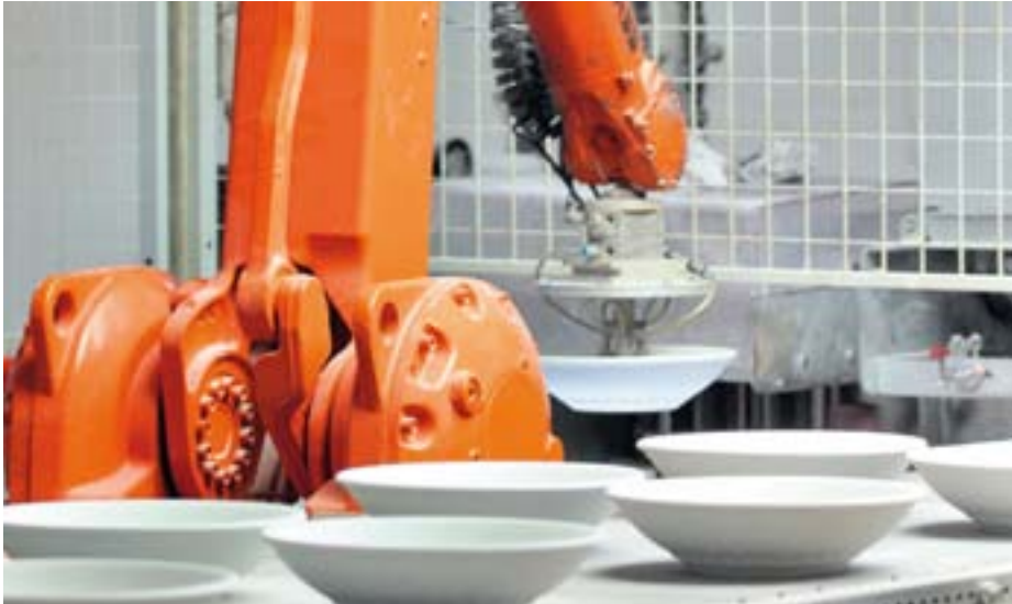
In der Tischkulturproduktion von Villeroy & Boch in Torgau fertigen ABB-Roboter Geschirr.
