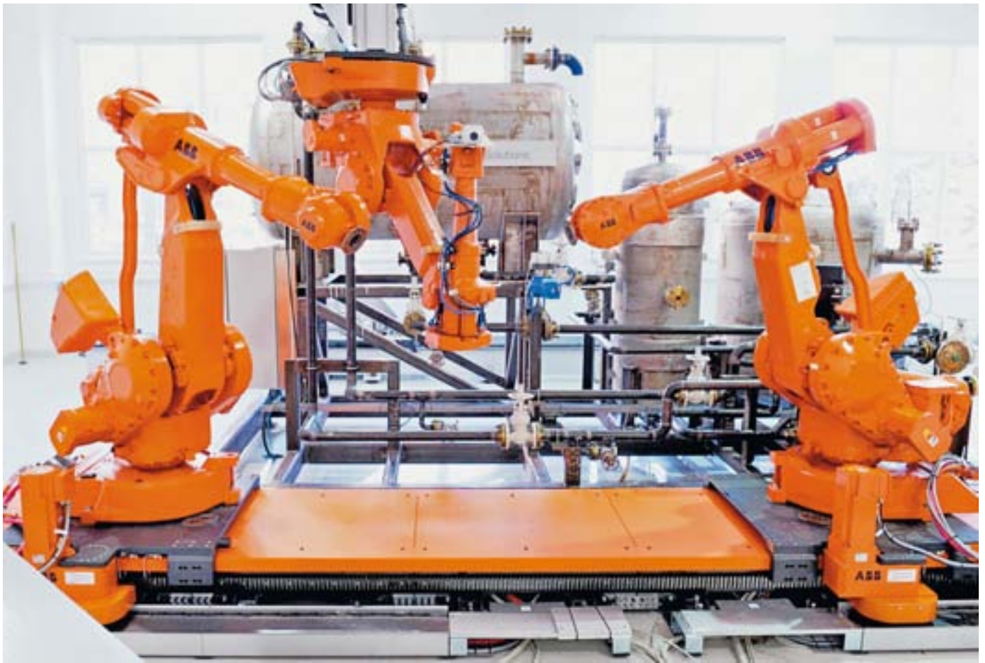
Die Anordnung für den Prototyp der Fernwartung umfasst einen portalmontierten IRB 2400 und zwei schienenmontierte IRB 4400.
