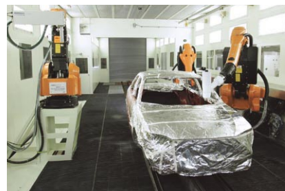
各種ペイントソリューションのテストを行うペイントブースには、最先端のエンハンスドロボット（右前）とプロセスアームロボット（右後）を装備しました
