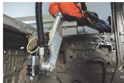
日本初のシーリング材塗布システムのデモンストレーション装置。高精度な自動化を実現できることから、さっそく日本国内のお客さまの注目を集めています
