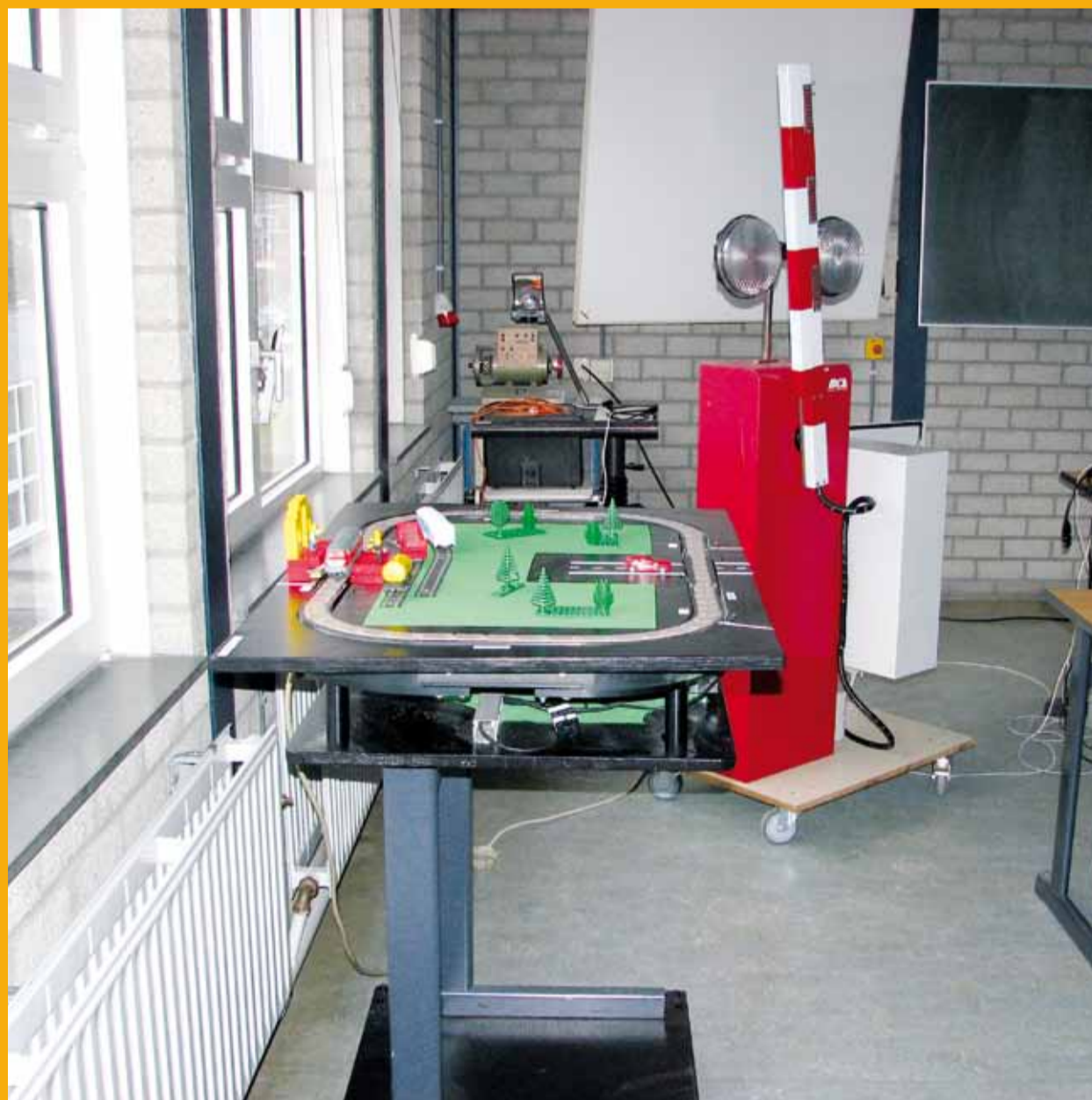
Als het modeltreintje de miniatuur overweg nadert, reageert de installatie met knipperende LED-lichten, zijn er geluidsignalen en gaat de slagboom naar beneden.
