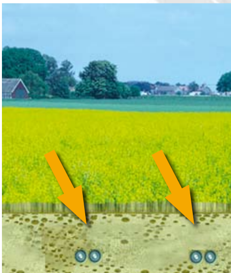
Onzichtbare energietransmissie met HVDC Light ® spaart landschap en milieu en geeft geen waardeverlies. Bovenstaande illustratie toont een verbinding in redundante uitvoering.
