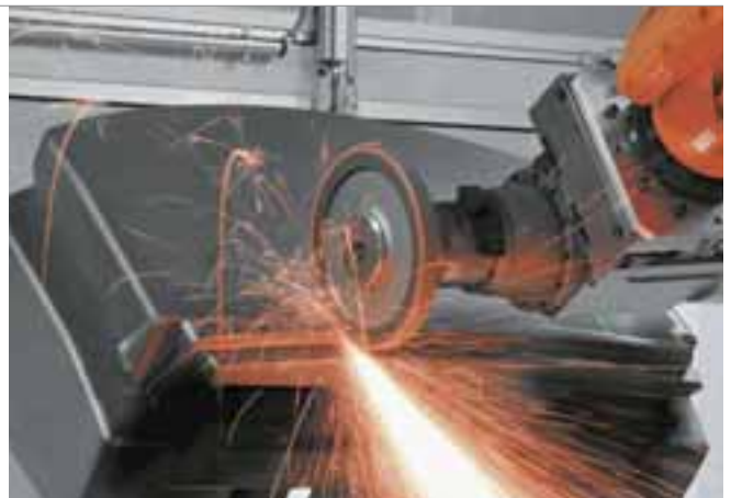
4 Процесс зачистки, при котором робот замедляется, столкнувшись с крупным заусенцем. Измеренное обрабатываемое усилие превышает установленную эталонную величину, что инициирует замедление движения робота. Когда усилие снизится, робот будет наращивать скорость до запрограммированного значения в течение 0,1 с.
