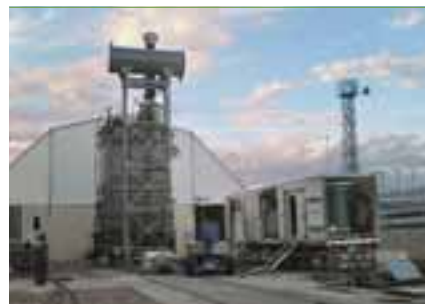
1б Типовая установка испытания трансформатора на атомной электростанции.
