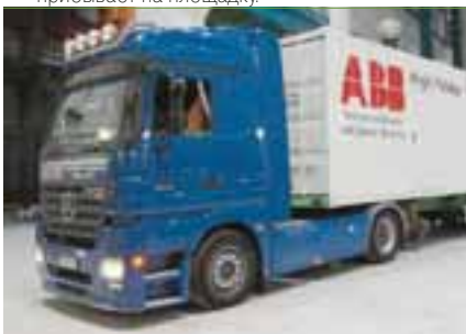
1а Мобильная установка высоковольтных испытаний, помещенная в 40-футовый контейнер, прибывает на площадку.
