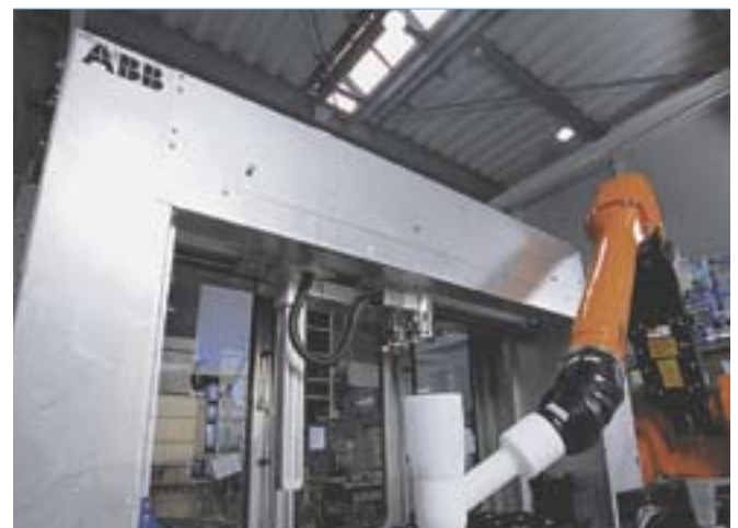
2 Окрасочный робот меняет кассету в манипуляторе. Пустая кассета автоматически перезаправляется
