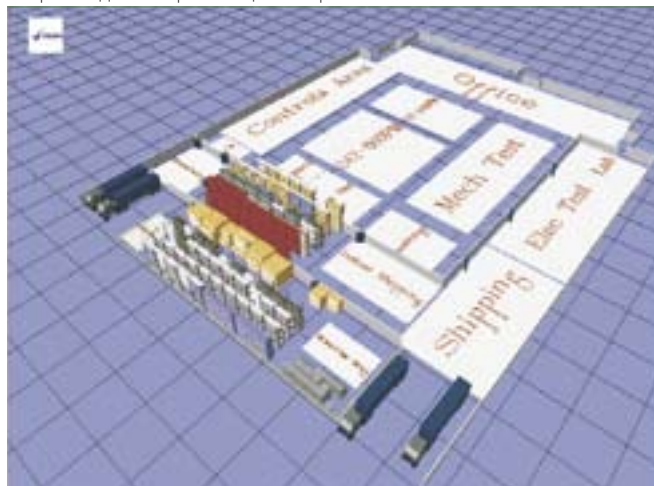
2 Для разработки и проверки новых производственных процессов применялись методы моделирования. Полученные результаты оказались очень ценными при выборе компоновки оборудования, определении объемов производства и организации материальных потоков
