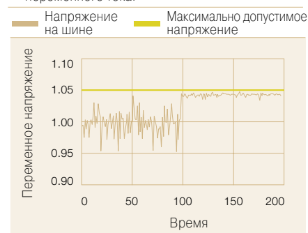
3 Линии HVDC повышают стабильность сетей переменного тока.
