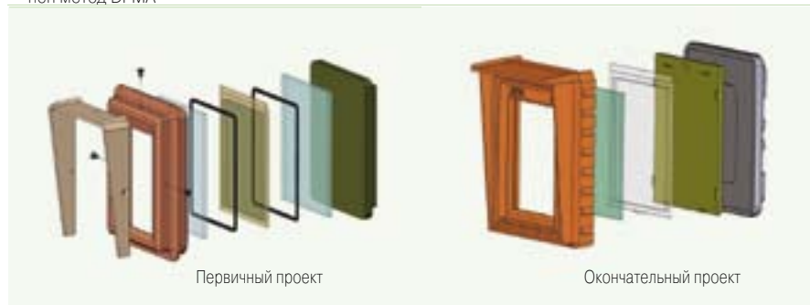
4 Пассивный индикатор напряжения PVI. При разработке на стадии эскизного проектирования применен метод DFMA
