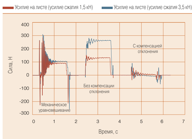
Б Усилие, прилагаемое к листу при силе сжатия 1,5 и 3,5 кН
