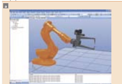
2 Этапы типового цикла точечной сварки, показанные с помощью программы RobotStudio фирмы АББ
