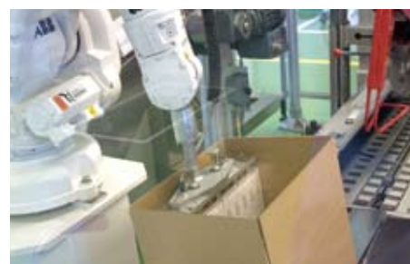
3 Robot vkladá jednotlivé škatuľky do finálnej veľkej škatule
