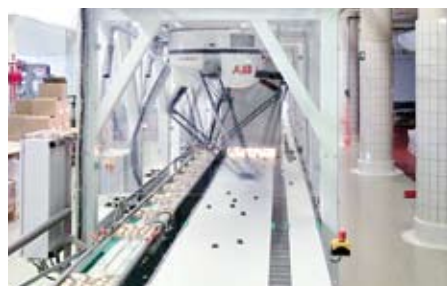
2 Robot odoberie produkt z pásu a umiestni ho na presné miesto do škatule na vedľajšom páse
